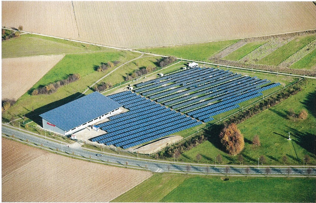
Gewerbegebiet Avantis, Aachen Dachanlage auf der PHOTON-Halle: Leistung 290 Kilowatt Freilandanlage: Leistung 747 Kilowatt
